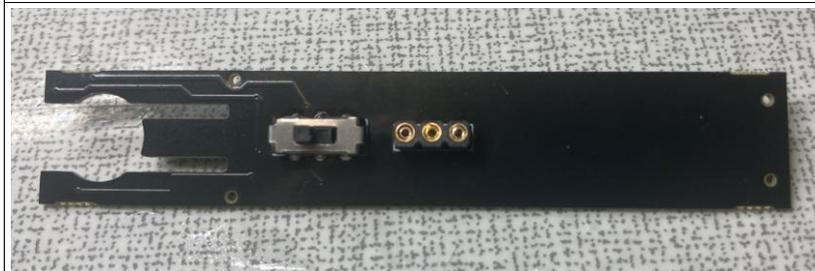
Zuerst wird die Ladebuchse und der Schalter von unten in die Platine eingesteckt und von oben (**Bestückungsseite**) verlötet.
