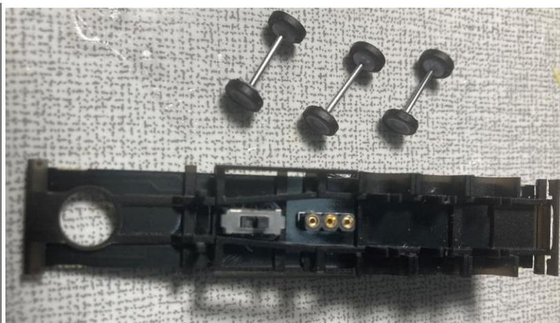
Die Felgen werden auf die Achsen aufgesteckt und die Reifen werden auf die Felgen aufgezogen.
