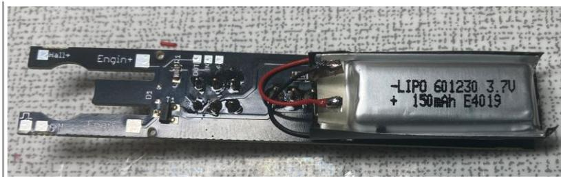
Der verwendete LiPo-Akku wird von unten mit Isolierband beklebt um Kurzschlüsse zu verhindern. Anschließend wird er mit Plus und Minus entsprechend verkabelt und mit doppelseitigem Klebeband auf der Platine platziert.
