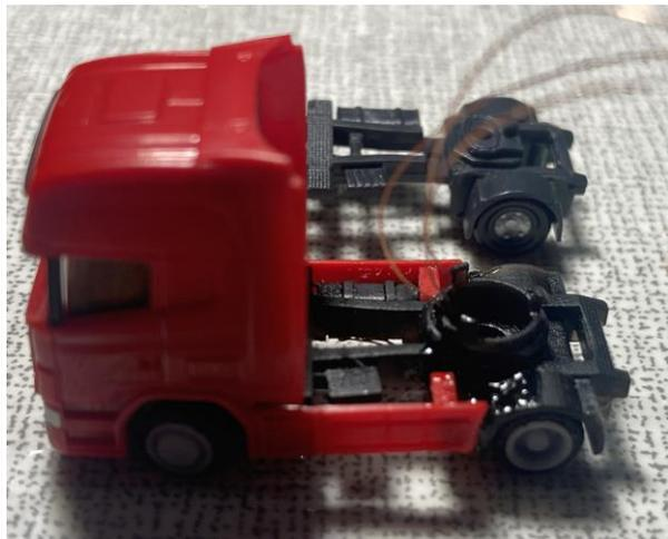
Bei der demontierten Zugmaschine muss der hintere Quersteg aufgetrennt werden.
